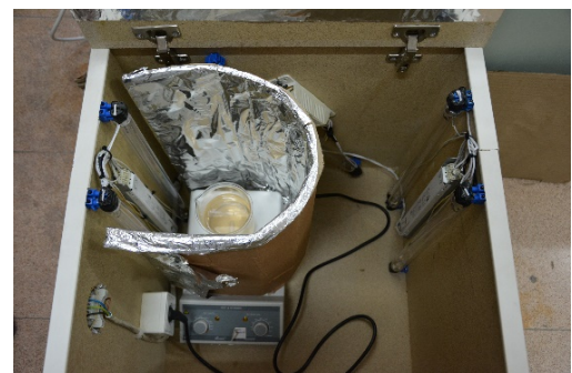
Şekil1: Deneylerde kullanılan UV-Fotooksidasyon deney düzeneği
