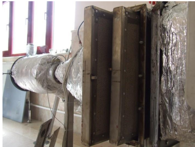
Şekil 5. Zeolit kasetlerin deney düzeneğine yerleşim şekli
